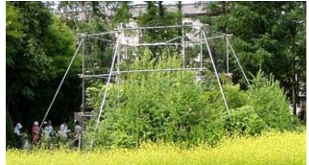
図 5. 北海道大学・北方生物圏フィールド科学センターの開放系CO 2 付加(FACE)施設(高さ5m;直径6.5m)。左下の学生さんの身長(約170cm)から大きさを想像ください。
